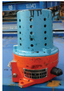
Průmyslový typ kouřového detektoru ( ^{241}\text{Am} )
