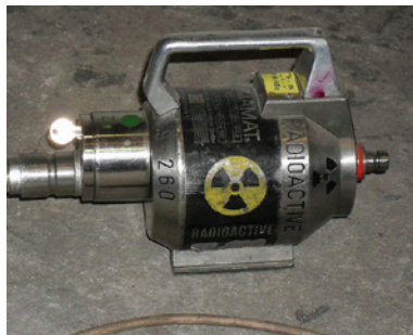
Defektoskopický pracovní kryt typ. GAMMAMAT ( ^{192}\text{Ir} , ^{75}\text{Se} )
