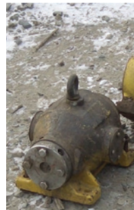
Hladinoměr, tzv. prasátko (nejčastěji ^{137}\text{Cs} )
