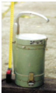
Olověný přepravní kontejner Vysoká hmotnost – různé druhy RA látek
