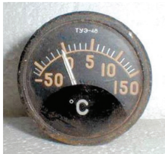
Stupnice – luminiscenční barva obsahující ^{226}\text{Ra} a ^{90}\text{Sr}
