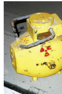
Hladinoměr, tzv. prasátko (nejčastěji ^{137}\text{Cs} )
