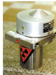
Popeloměr (obsahuje dva ZIZ – ^{241}\text{Am} , ^{137}\text{Cs} )
